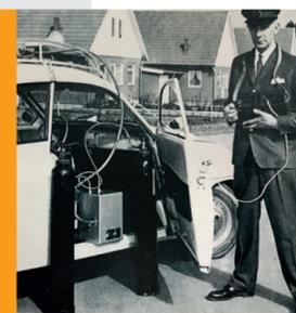
Kockum Sonics entwickelt die erste mobile Sirene mit Druckluftflaschen.
